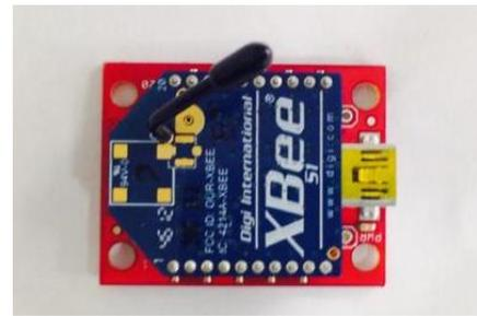
Fig 4. Antena Receptora Xbee
