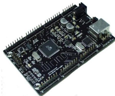
Fig 5. Plataforma de prototipado Electrónico, Wiring.
