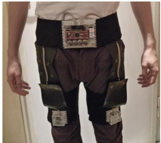
Fig 14. Tercer prototipo del dispositivo Dynamo.
