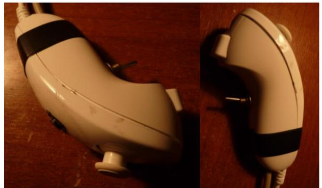
Fig 18. Control Nunchuck con pulsador y Switch.
