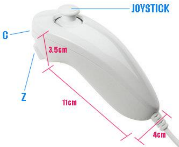
Fig 1. Medidas y especificaciones del control.
