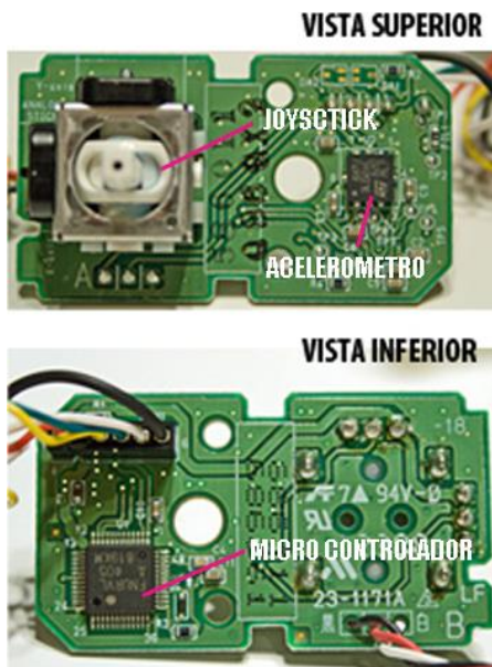
Fig 5. Componentes electrónicos del control.
