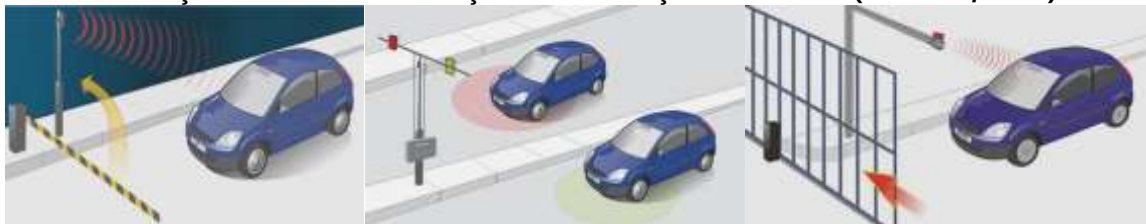
Utilização do RFID na localização e identificação de veículos (Oxxcode, 2011)
