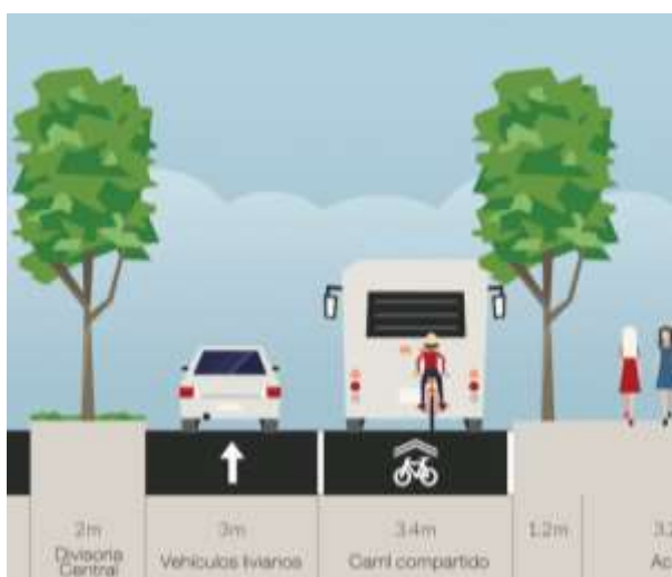
Imagen 4: Intervención sugerida para secciones de dos canales
