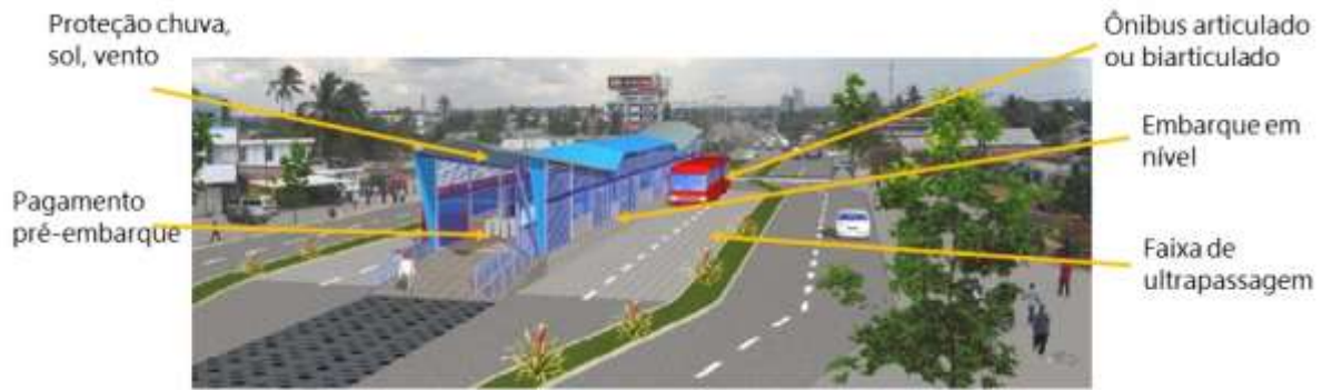
Figura 13 Exemplo de estação do sistema BRT
