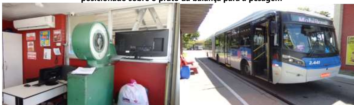
Figuras 3 e 4: Balança utilizada para a pesagem dos ônibus e ônibus do corredor Leste/Oeste posicionado sobre o prato da balança para a pesagem
