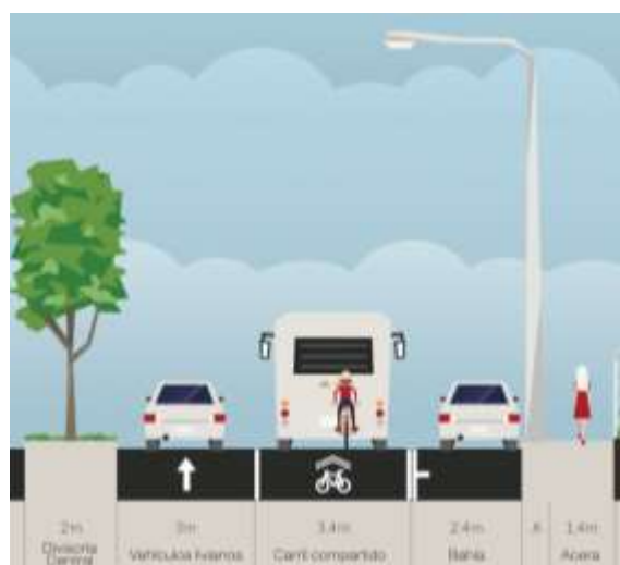
Imagen 5: Intervención sugerida para secciones de tres canales
