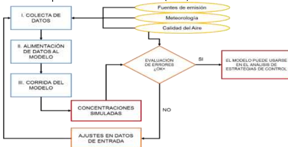
Figura 1. Esquema de metodología a seguir para realizar modelamiento de dispersión de contaminante (COV) en el aire [2].
