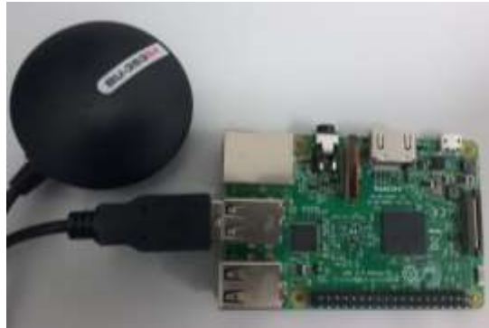
Figura 84: Computador ( sniffer ) utilizado: Raspberry PI 3 Model B, com sensor GPS e placa Wi-Fi.
